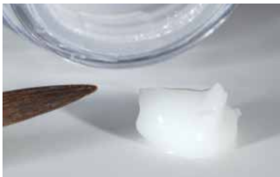
IPS Ivocolor Glaze Paste vor der Entnahme aus der Dose mit einem Achatpatel durchmischen.
