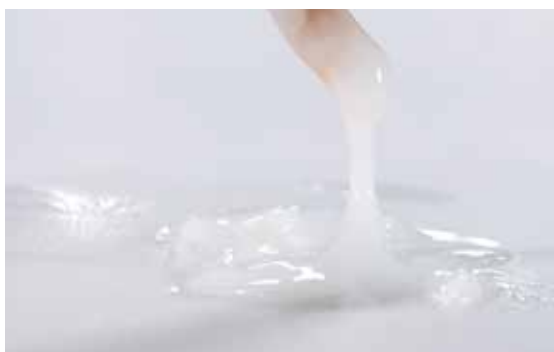
Bei korrekter Anmischung darf die Konsistenz der Glasur nicht zu dünnflüssig sein.
