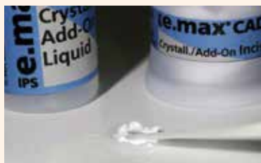
Anmischen des IPS e.max CAD Crystall./Add-On mit IPS e.max CAD Crystall./Add-On Liquid zu einer modellierfähigen Konsistenz
