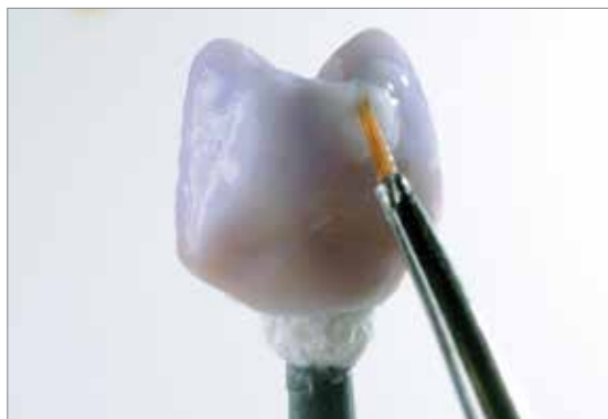
Optional: Geringfügige Formkorrekturen (z.B. approximale Kontaktpunkte) mit IPS e.max CAD Crystall./Add-On ergänzen.
