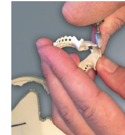
Verschleifen der Haltestege & prüfen der Passung
